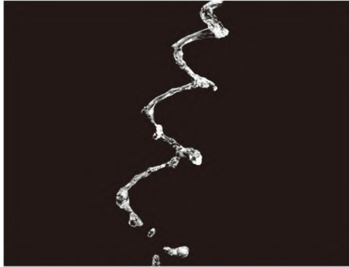
水流因為喇叭傳出的聲音振動而改變形狀
