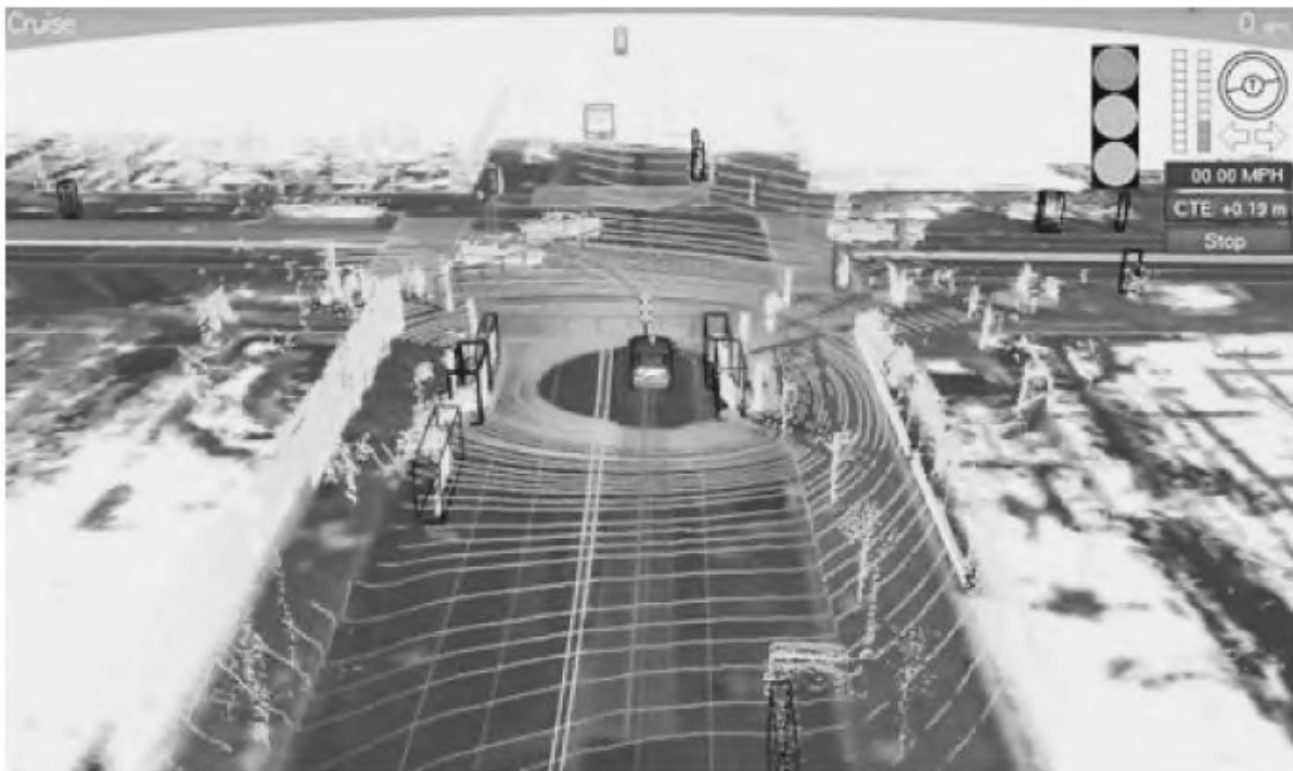
图2-2 使用激光雷达可精确还原车辆环境
